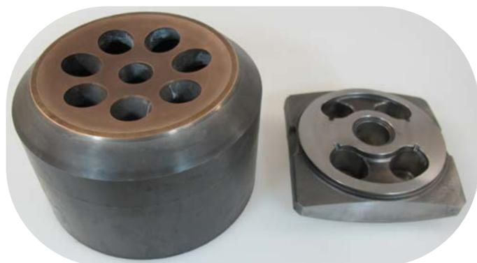
*Corpo e piastra inclinata di una pompa a pistoni da 125 mm lappati in accoppiamento*
