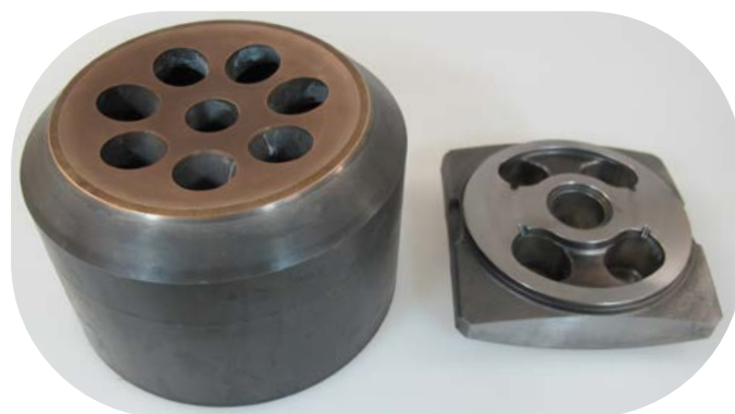
Párové lapování 125mm těla pístového čerpadla a kyvné desky
