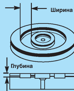
Кольцевая конусообразная канавка
